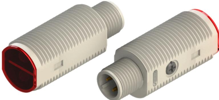
Sensores fotoelétricos com supressão de fundo são dispositivos utilizados para detectar objetos com alta precisão, mesmo em ambientes com fundos refletivos ou complexos. Eles funcionam com base na emissão e recepção de luz, normalmente LED, e utilizam tecnologia que permite distinguir o objeto do fundo com base na distância e no ângulo de reflexão.
